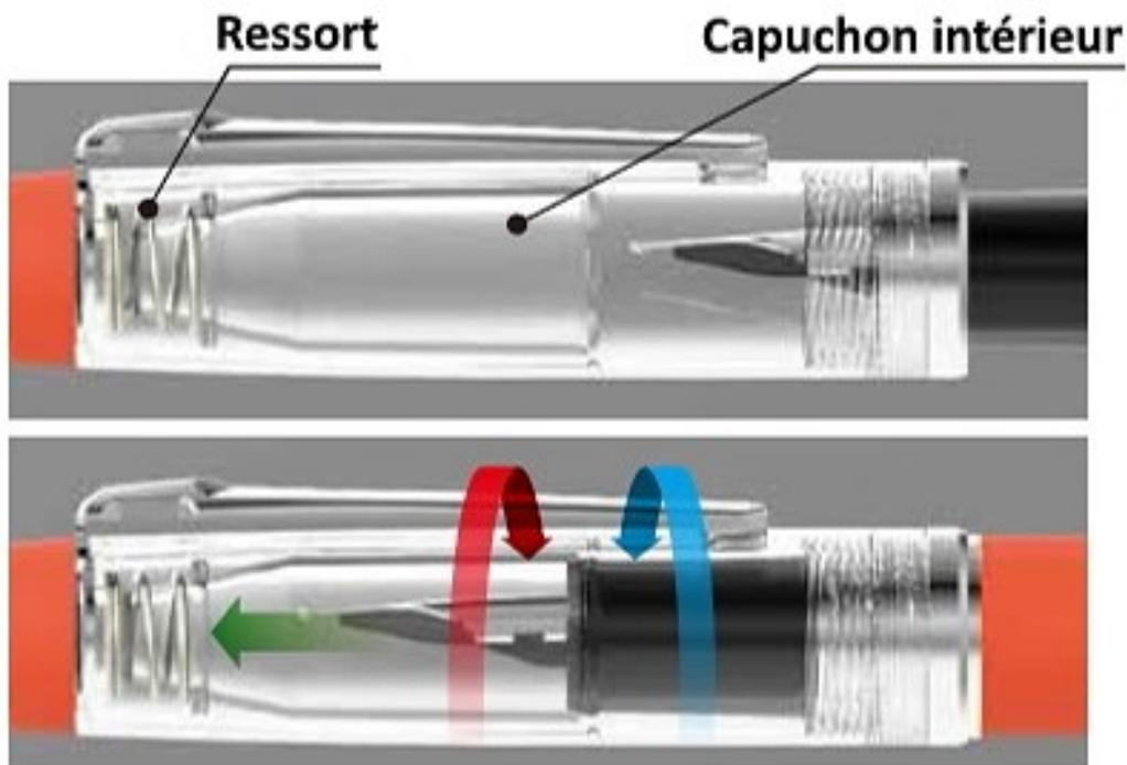
Le baril et le capuchon intérieur sont étroitement liés l'un à l'autre lorsque vous fermez le capuchon. Le capuchon intérieur se déplace vers l'extrémité lorsque le baril tourne pendant que le ressort maintient rapidement le capuchon intérieur pour maintenir une étanchéité à l'air complète.
